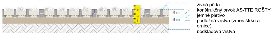
Obrázok č. 1: Zelený systém AS-TTE ROŠTY ® konštrukčný princíp 1
